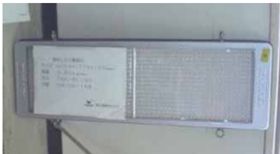
写真1 イカ釣りでの試験に用いた パネル型LED集魚灯
