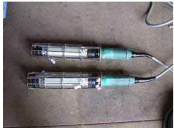
写真2 まき網での試験に用いた LED水中灯
